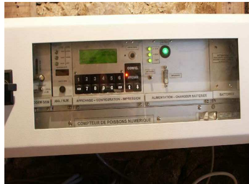
Illustration 5 : A gauche : capteur installé dans un des bassins de la passe ; à droite : boîtier du compteur à résistivité.
