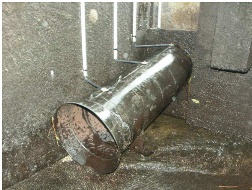
Illustration 5 : A gauche : capteur installé dans un des bassins de la passe ; à droite : boîtier du compteur à résistivité.
