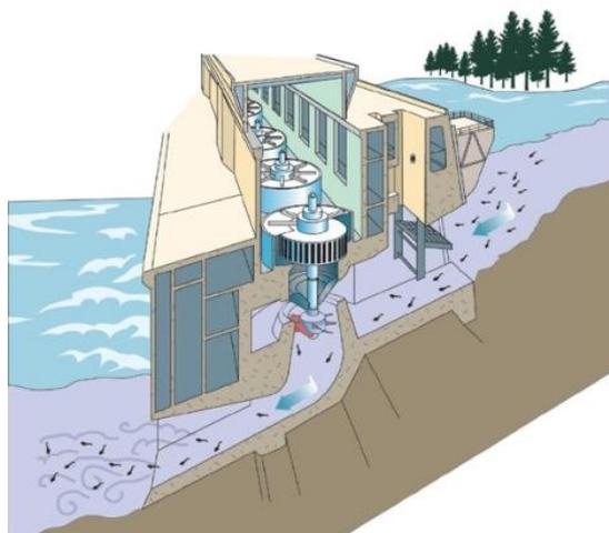
Figure 4 : Section simplifiée d'une installation hydroélectrique typique montrant la prise d'eau, la turbine (type Kaplan), les conduites et le flux de sortie. Les poissons entrent dans la turbine et traversent ses composants lors de leur dévalaison.
