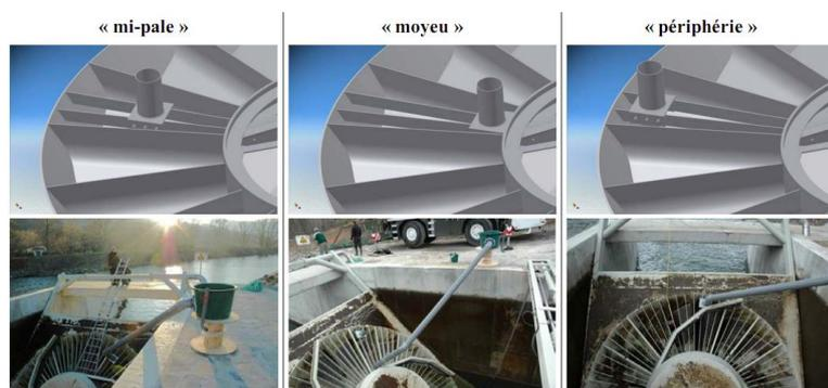
Figure 10 : Points d'insertion des anguilles dans la turbine VLH lors des tests à Millau en 2007.
